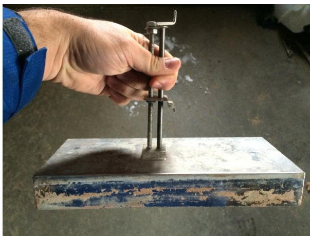
Photo 8 : Le flotteur peut ne pas remplir adéquatement son rôle s'il n'est plus étanche et si des dépôts y adhèrent.
